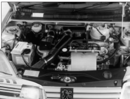
Le moteur qui fait toute la différence. Un "petit" 1600 qui grimpe allègrement dans les tours, généreusement gavé par une injection électronique Bosch-L-Jetronic et une pompe à essence électrique.
